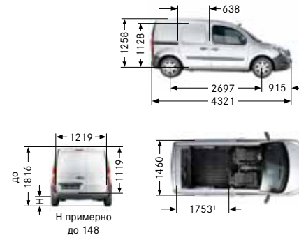
Удлиненный фургон с колесной базой 2697 мм
